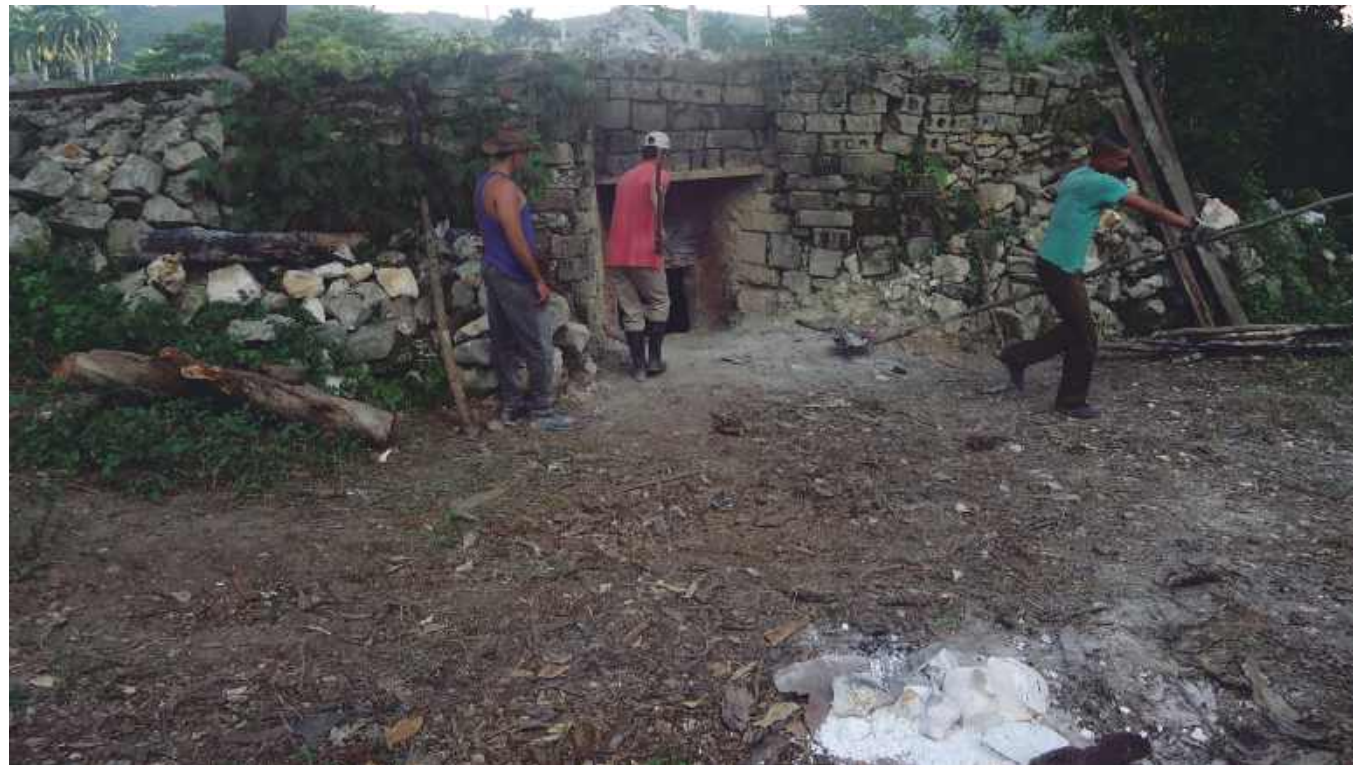
Preparación de un horno de cal
