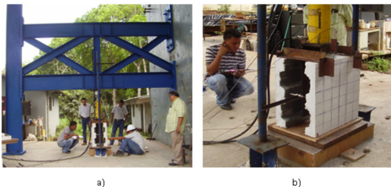
Figura 2. Ensayo de conexiones con lámina plegada perpendicular. a) Vista general del ensayo. b) Detalle del espécimen. Fuentes: Elaboración propia.
